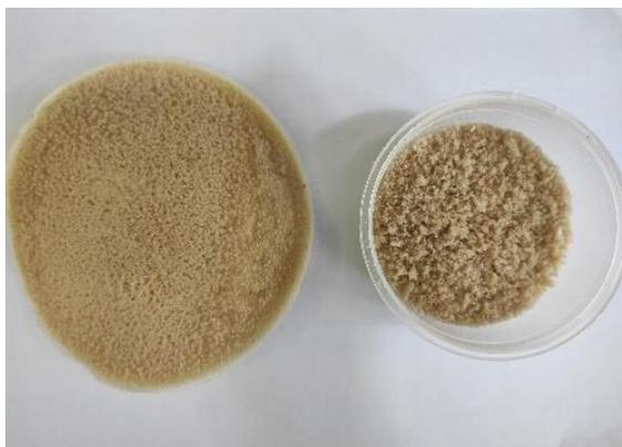
Рис. 3. Лيوфилизат КГ пористой структуры (слева) и измельченный в порошок (справа)
