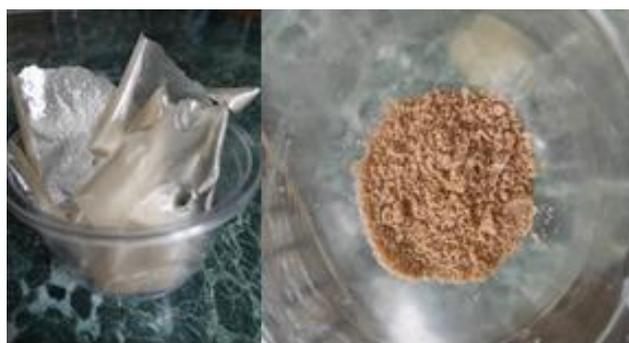
Рис. 4. Высушенный при температуре 50 °С КГ в виде пленки (слева) и измельченный в порошок (справа)
