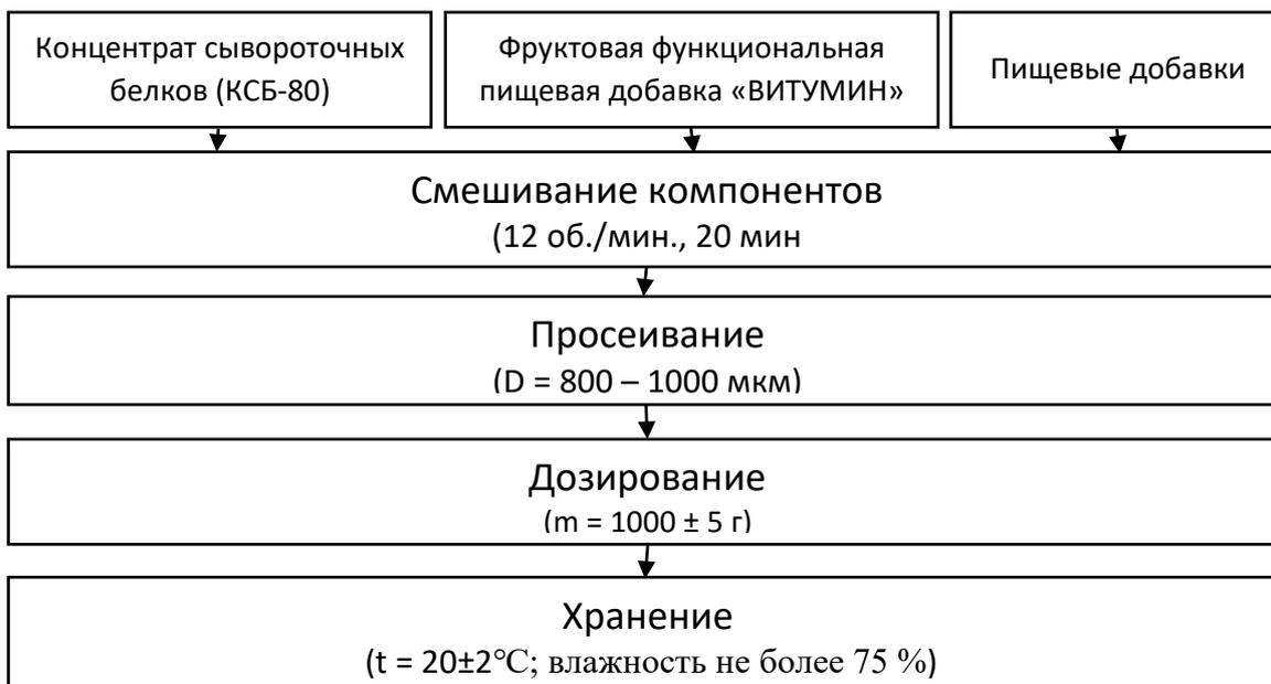
Рис. 3. Технологическая схема получения специализированного белково-углеводного напитка «BioCarb» в сухой форме
