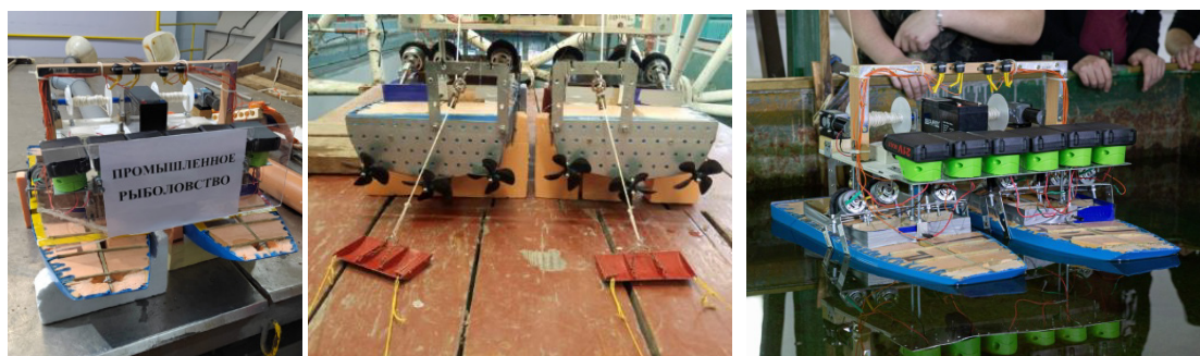
Рис. 4. Модель катамарана ПК-1 с двигателями, аккумуляторами и траловыми лебедками
