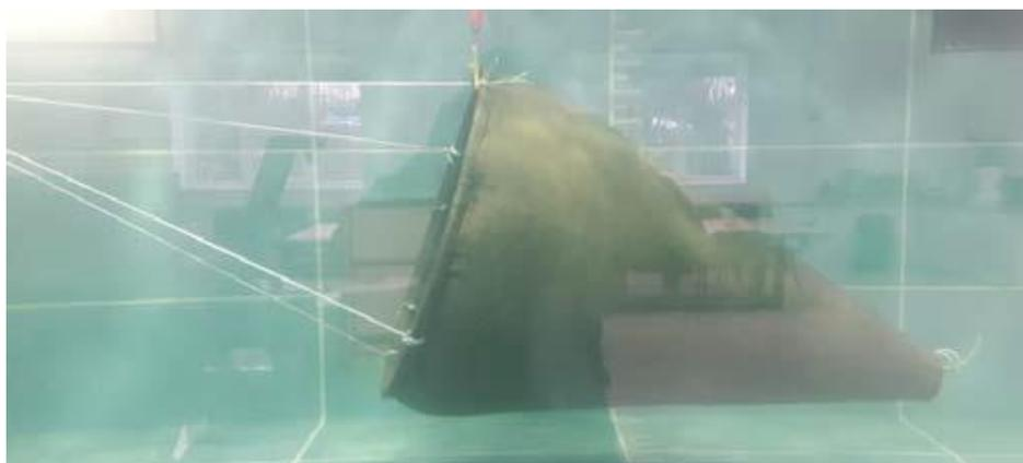
Рис. 5. Плавающий якорь в ходе экспериментов
