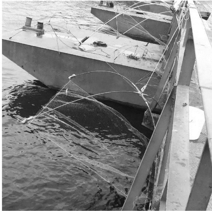
Рис. 2. Отцеживающее орудие лова – подъемник («паук»)
