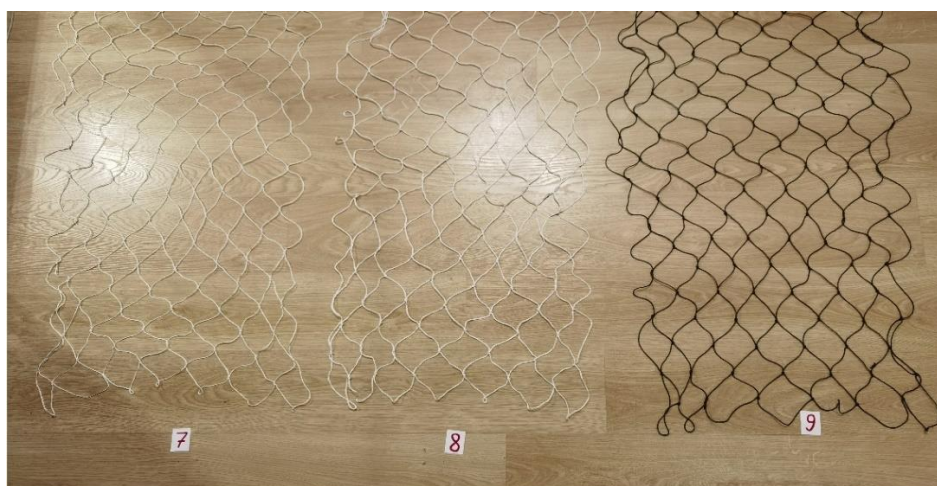
Рис. 4. Образцы сетных полотен с шагом ячеи 80 мм Fig. 4. Samples of mesh webs with a mesh pitch of 80 mm
