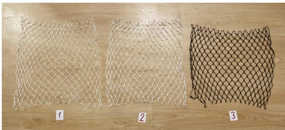
Рис. 2. Образцы сетных полотен с шагом ячеи 30 мм Fig. 2. Samples of mesh webs with a mesh pitch of 30 mm
