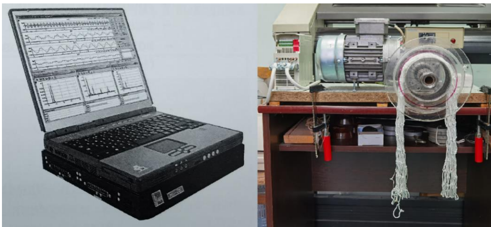
Рис. 5. Изображение тензостанции "MIC-200" и тянущего привода Fig. 5. Image of strain-station "MIC-200" and traction gear
