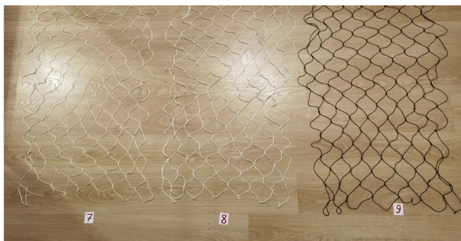
Рис. 3. Образцы сетных полотен с шагом ячеей 80 мм Fig. 3. Samples of net webs with a mesh pitch of 80 mm
