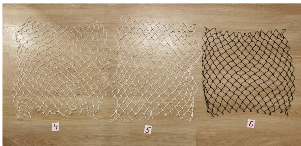
Рис. 2. Образцы сетных полотен с шагом ячеей 40 мм Fig. 2. Samples of net webs with a mesh pitch of 40 mm
