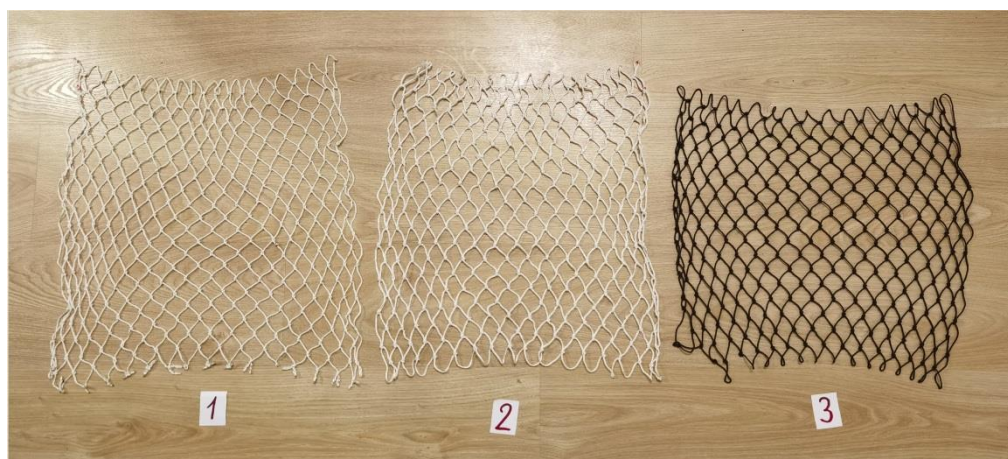
Рис. 1. Образцы сетных полотен с шагом ячеей 30 мм
