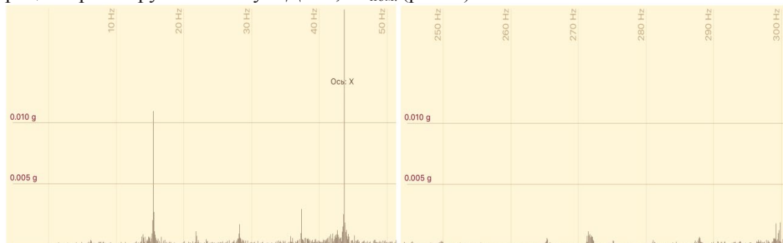
Рис. 7. Спектр вибраций исследуемого двигателя от 0 до 50 Гц и от 250 до 300 Гц при 10 %-й нагрузке на валу
