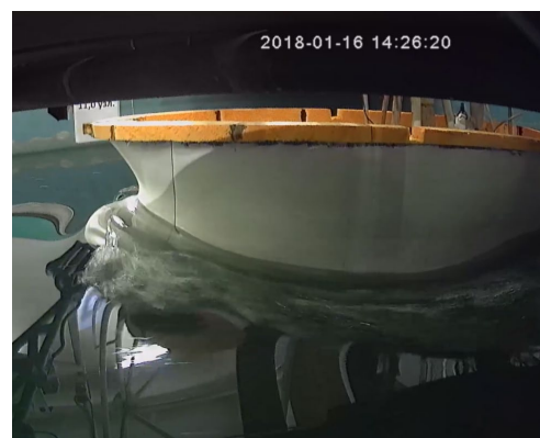
Рис. 7. Испытания МРКТ «Адомат». Начальный дифферент на корму, скорость 11 узлов
