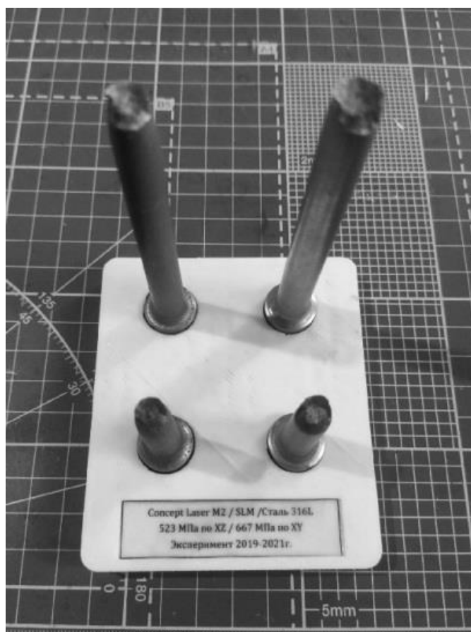
Рис. 2. Горизонтальный и вертикальный образец после испытаний Fig. 2. Horizontal and vertical specimen after testing
