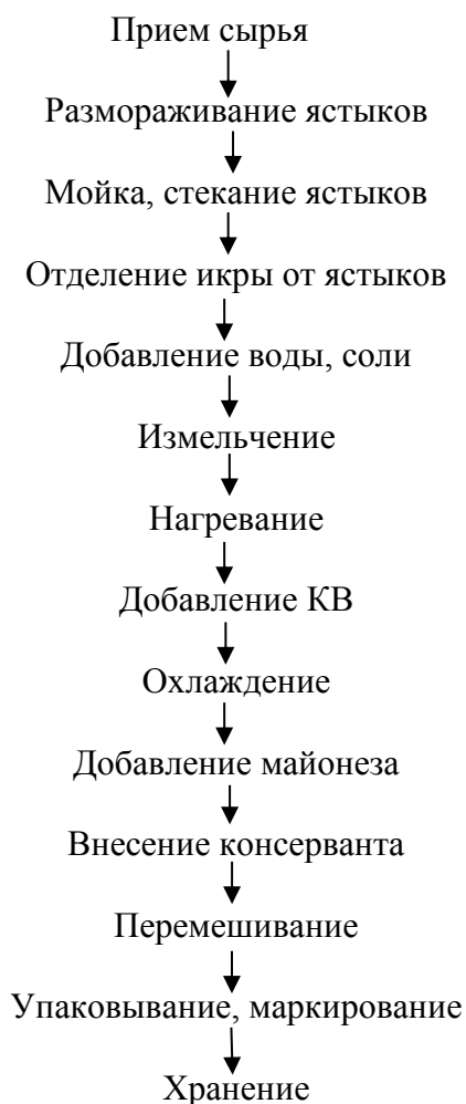
Рис. 6. Технологическая схема производства икорно-майонезного соуса с КВ Fig. 6. Production scheme of a caviar-mayonnaise sauce with CF
