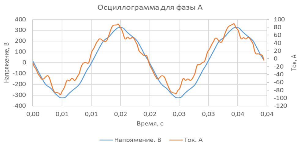
Рис. 4. Осциллограммы напряжения и тока в цепи низкой стороны трансформатора Fig. 4. Voltage and current waveforms in the low side circuit of the transformer
