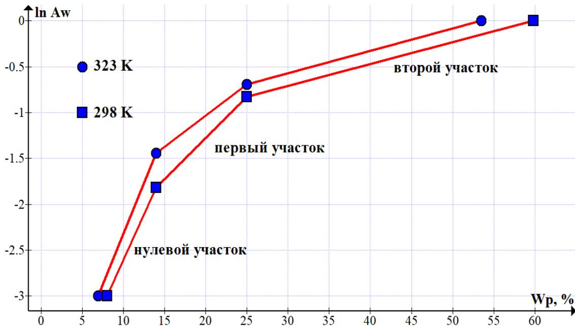
Рис. 2. Кривые равновесия, построенные в полулогарифмических координатах
