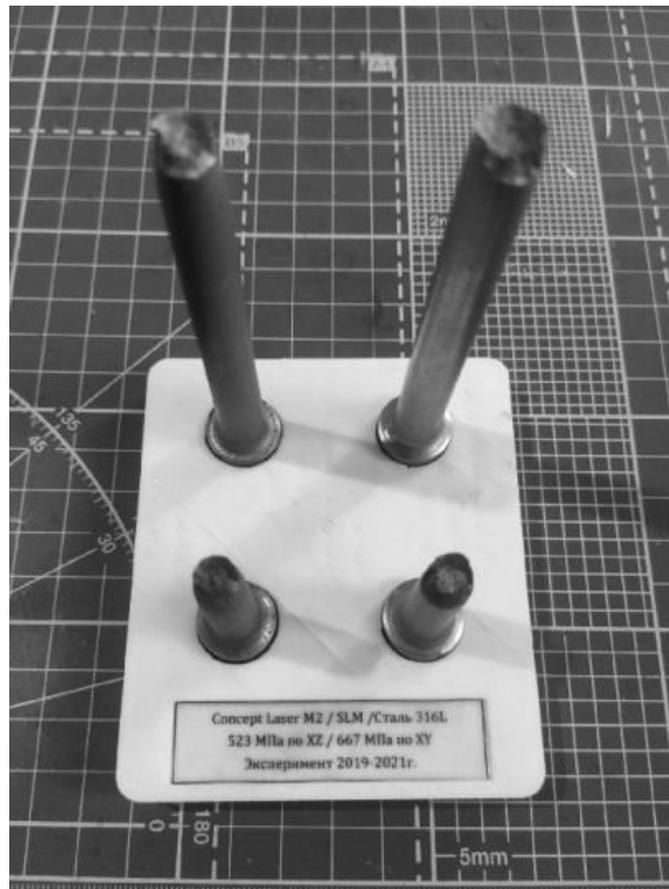
Рис. 2. Горизонтальный и вертикальный образец после испытаний
